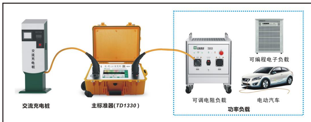
充电桩现场检测连接图
