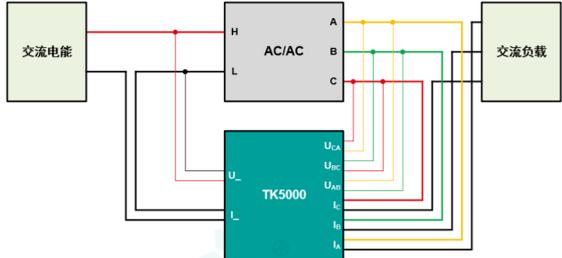
TK5000采用高达20位的高速ADC，具有50 kSPs的高采样率，实现宽动态范围的宽频信号同步采样，在电压电流测量量程范围内，其工频条件下功率/电能的测量精度达到±0.02%，能准确测量得到输入测和输出测的电量值。系统的谐波测量功能可得到各测量通道的电压/电流信号的各次谐波分量表（如图a），并可分析查看其谐波频谱特性（如图b），用于分析在不同频率下变频器的谐波含量。
