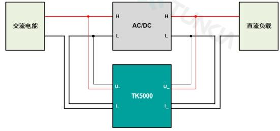
TK5000具有较宽的测量范围，交流电压测量最高500 V，交流电流测量最高390 A，测量频带为DC ~ 50 kHz，在全量程范围内交直流电压电流的测量准确度达到0.01级。可测量最低10 mW的直流功耗，满足开关电源和LED照明设备对于低值功率的测量需求。
