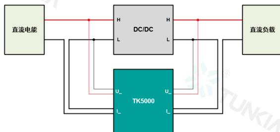
TK5000具有直流电能输入侧和输出侧的高精度同步测量功能,输入侧与输出侧的电压、电流、功率、电能等电参量可进行瞬态比较,并给出输入侧与输出侧功率、能量的差值与能效评价,其电压/电流测量不确定度高达0.01%,功率/电能测量不确定度高达0.02%,通过网络可把输入侧与输出侧的同步测量结果传送到计算机,方便研究人员进行系统的能效分析与研究。
