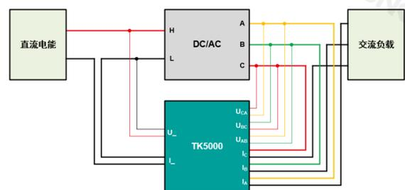
TK5000的输入测与输出测均可以测量直流、单相交流和三相交流的电压、电流、频率、功率和电能,并可同屏显示三相电量的向量图(如图a)和电压/电流的波形图(如图b),并对信号波形和测量数据等进行录波存储,为深度的计算分析做技术支持。
