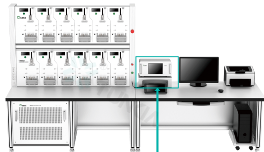
作为0.02级/0.05级R46单相电能表检定装置的标准电能表
